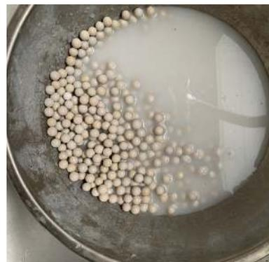
**Figure 5** - Média neutralisant après rinçage à l'eau claire
