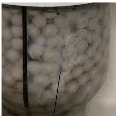
**Figure 4** - Précipité de sel déposé sur le média neutralisant des échangeurs de chaleur en aluminium
