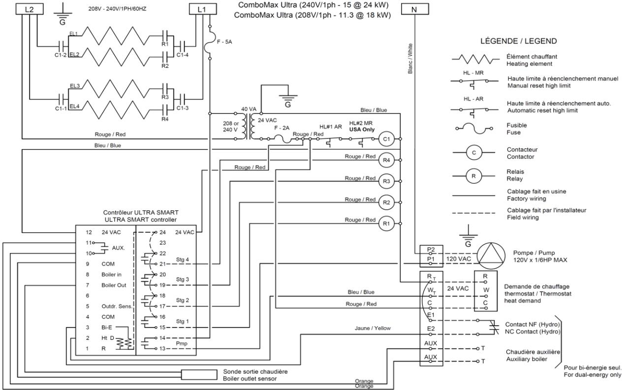
Diagramme électrique / Wiring Diagram
