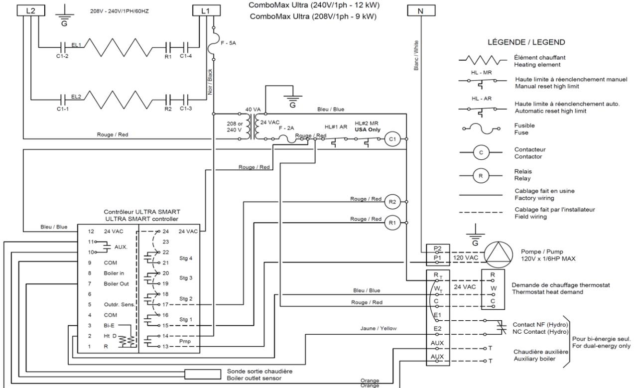
Diagramme électrique / Wiring Diagram
